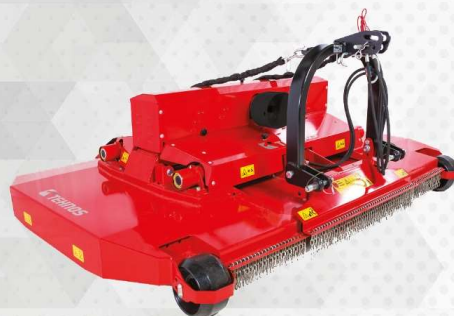
MTV2 Vario - Kreiselmulcher Arbeitsbreite 128-162 cm, Seitenver- schiebung 34 cm, Heckenbaubock, Schwimmende Anpassung des Mul- chers an unebene Flächen, Einstell- bare Arbeitshöhe, hydr. einstellbare variable Arbeitsbreite, Gelenkwelle Walterscheid
