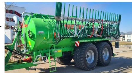
Station: Krailshausen, OEHLER 15/18m Schleppschauch mit Saugarm
